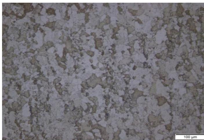
**Figura 03 - Micrografia do aço 410 como recebido, apresentando inclusões finas de óxidos**
